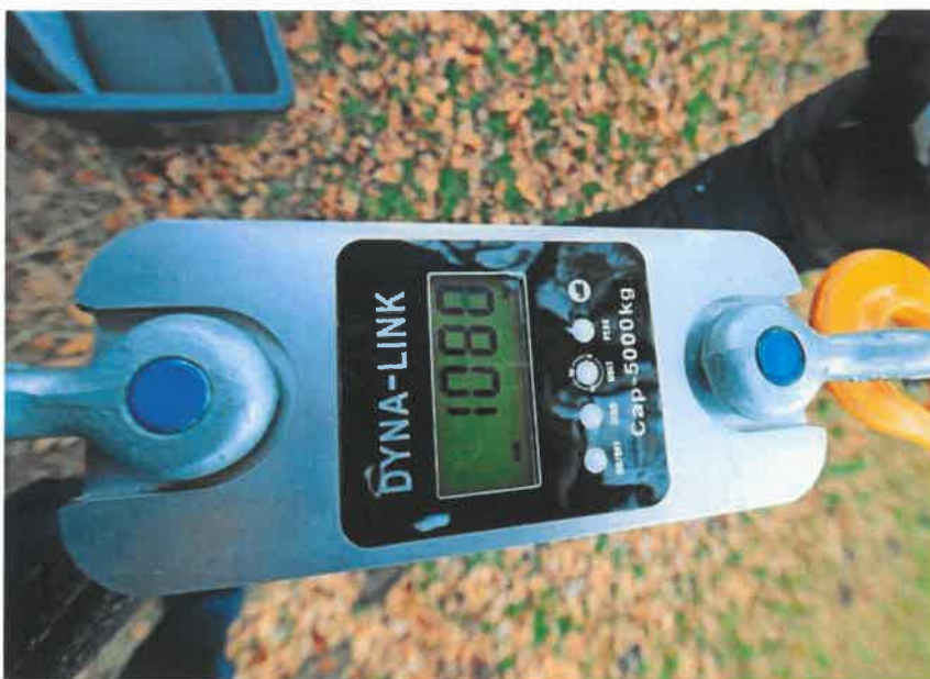
Dort, wo die Ratsche betätigt wird, zeigt das Gerät, wie viel Kraft auf den Baum einwirkt – hier sind es 1,08 Tonnen. Quelle: Lutz Roeßler
